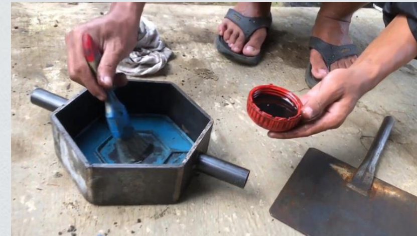
Mengoleskan oli ke dasar cetakan
